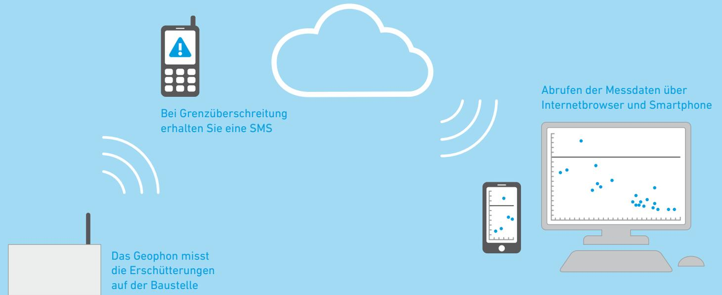
Schwingungsmessungen und kontinuierliche Erschütterungsüberwachung dienen auf Baustellen zur Beweissicherung diverser Bautätigkeiten, sowie zur möglichen Bauschadenbeurteilung oder Schadenabwehr.
